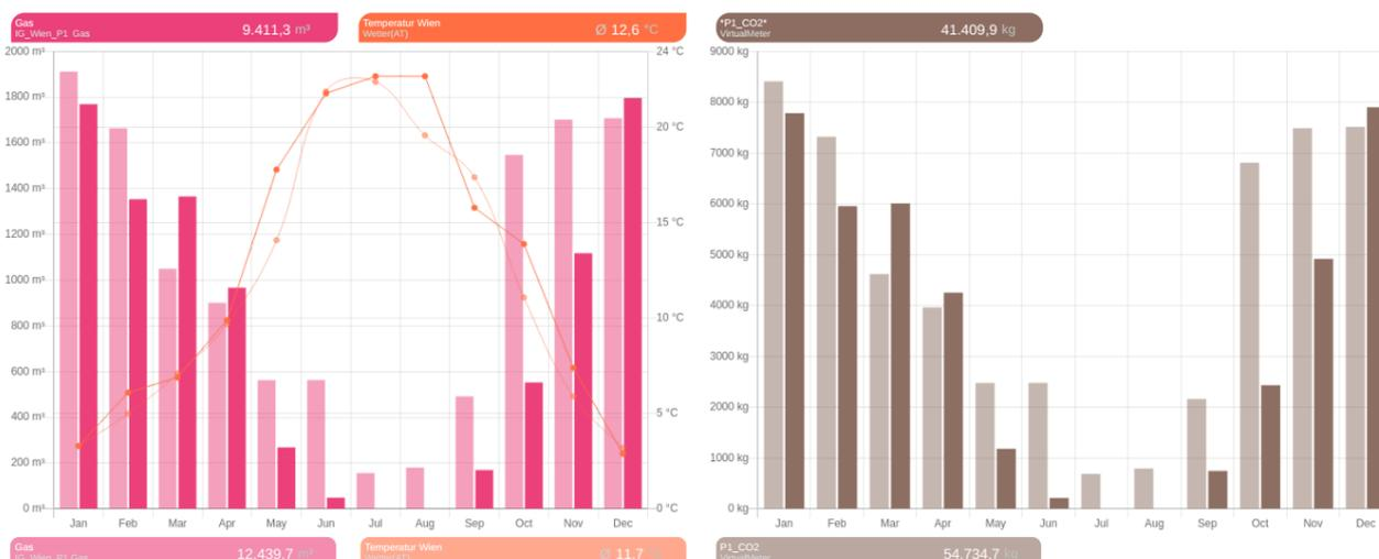
Abbildung 3: Beispiel eines Auswertungsdiagramms für ein gasversorgtes Gebäude - dargestellt nach Gasverbrauch, Außentemperaturen, CO2-Emissionen pro Monat für zwei Jahre (vor und nach der Optimierung)
